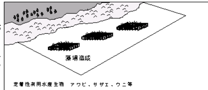
定着性のアワビ、サザエ等を対象とした地先型増殖場造成概念図
